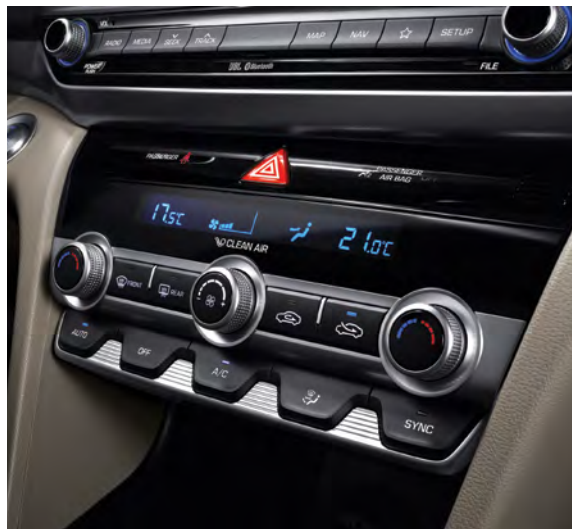
Climatiseur à régulation automatique double zone avec désembueur de pare-brise automatique
