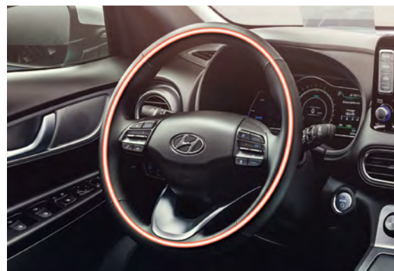
Volant chauffant de série avec leviers de contrôle du freinage régénératif
